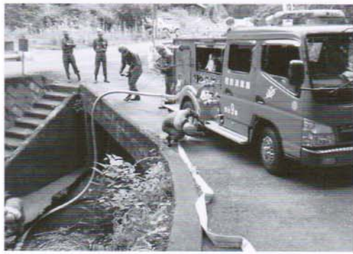
水を吸い上げるポンプ車両
